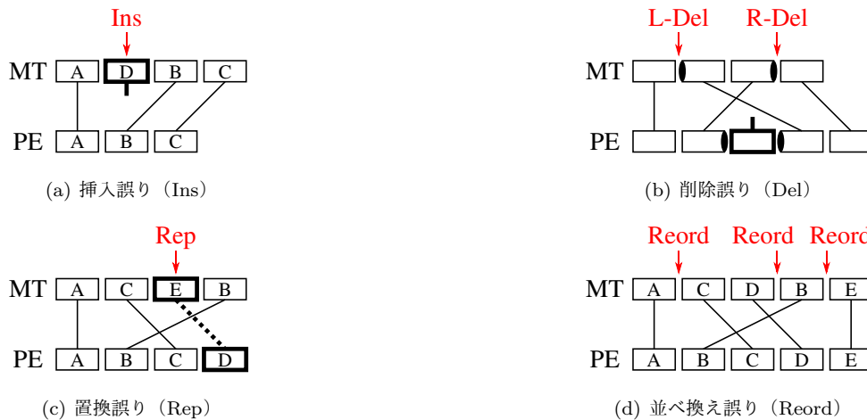
図 3 アライメントによるラベル付与の例。評価者が赤矢印の位置を見ることは、分析により太線のアライメントが検出されることに対応する。
