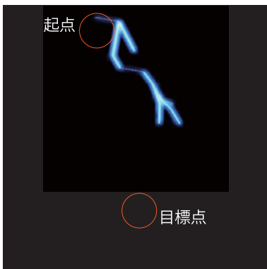
図 12 目標点付近まで達しない放電経路
