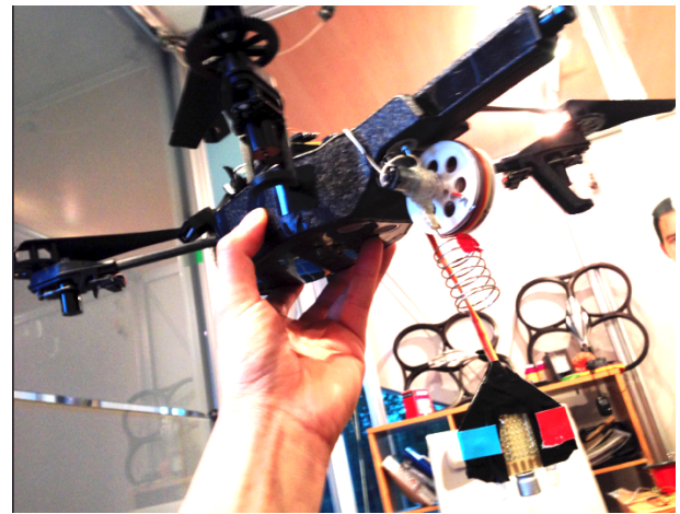
図 8 En-1 に取り付けられたケーブル巻き取り装置
