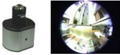
図 3. カメラ機器と魚眼レンズを装着した画像
