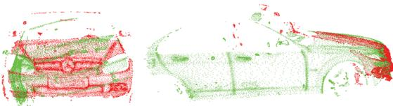
図 16 提案手法による 0-1 方向の点群の位置合わせ結果
