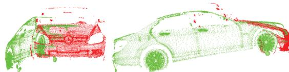
図 20 提案手法+ICP による 0-2 方向の点群の位置合わせ結果
