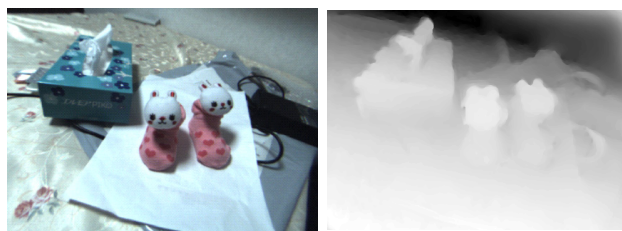
図9 全体最適化による奥行き推定結果。(左)入力画像の一部、(右)奥行き推定結果。
