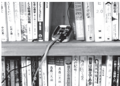
図 6 実験に用いた AC 電源周波数センサーの設置例
