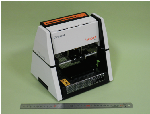
図 1 3D 切削加工機 iModela IM-01
