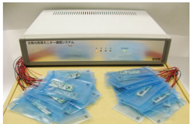
図 3.3 発電モニタ通信装置親機
