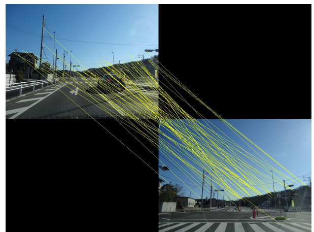
図 7 特徴点の対応付けを可視化した結果 (図 4(a)(b)) Fig. 7 Result of feature points matching with Fig. 4(a)(b)
