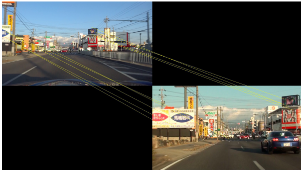
図 10 特徴点の対応付けを可視化した結果 (図 9(a)(b)) Fig. 10 Result of feature points matching with Fig. 9(a)(b)
