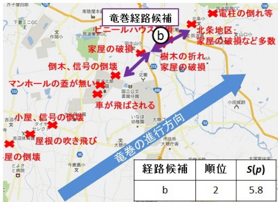
図 12 経路候補と竜巻による被害の概況と分布 Fig. 12 Damages caused by the tornado and a path candidate.
