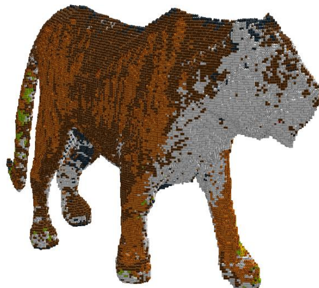
図 11 トラのコンピュータ上のレゴブロックモデル(SFS 法における八分木の最大深さ 8)
