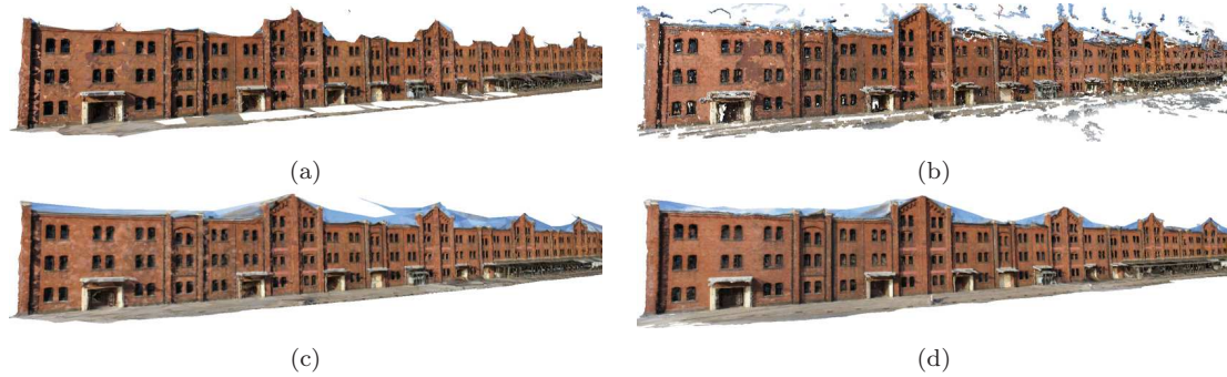
図 8 既存手法との定性的な比較. (a) 提案手法. (b) PMVS [7] による色付けされた密な点群. (c) 提案手法と同じ入力を与える, 平面走査法を行わない CMPMVS. (d) CMPMVS [10].
