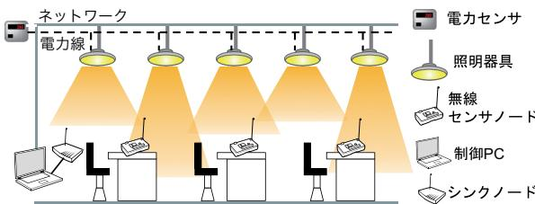
図 2 知的照明システムの構成イメージ
