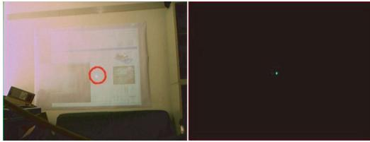
図2 カメラ画像の例。左：フィルタを装着していないとき。右：フィルタ装着後
