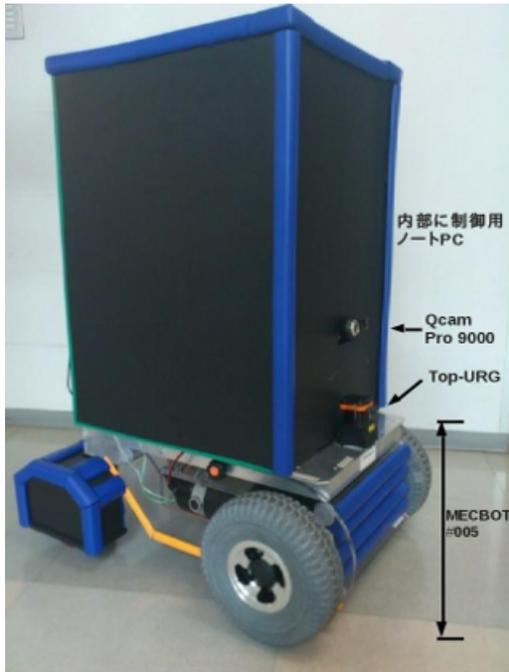
図 6 車両型ロボットの外観
