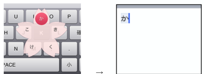
図 4 「K」キー上でフリック操作を行なうことにより「か」を入力
