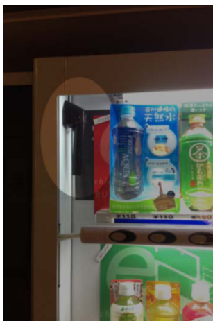
図 5 自動販売機の金属面に設置された外部アンテナ Fig. 5 External antenna on vending machine.
