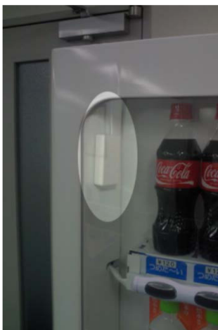
図 4 自動販売機の金属面に設置された小型アンテナ Fig. 4 Miniaturized antenna on vending machine.
