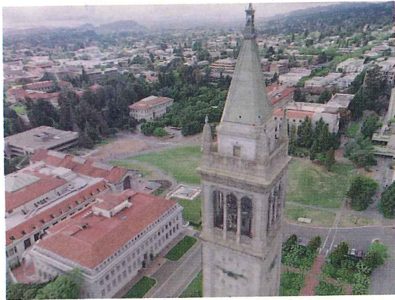
図-3 16枚の写真画像から鐘楼を3DCGで構築する (Siggraph97 Visual Proceedings page 254 "FACADE")
