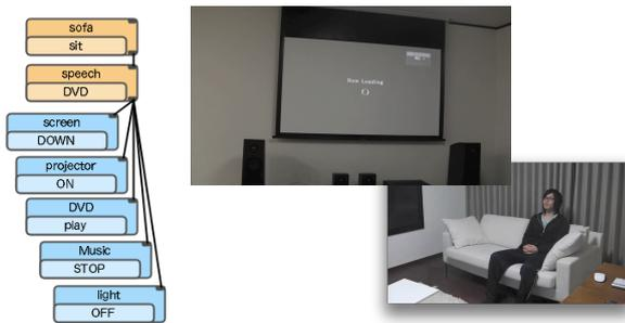
図 8 本システムを用いた家電機器統合制御の例
