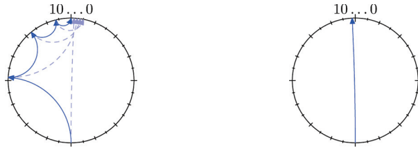
(a) successor からなる finger テーブル . 点線により示される finger は目標 ID を少しだけ超えてしまうため、その約半分しか進むことのできない 1 つ手前の finger が使用される (b) predecessor からなる finger テーブル . 1 回の転送によって目標 ID の少し手前まで進むことができる
