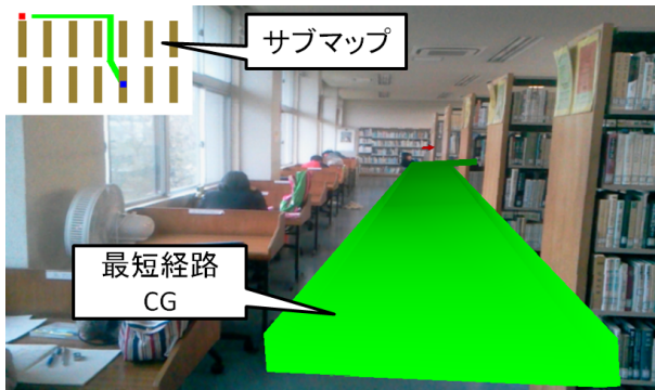
図 8 案内情報 CG の表示 (移動途中) Fig. 8 Display the navigation CG (moving)
