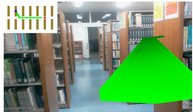
図 14 案内情報 CG の誤表示 Fig. 14 Error in CG-based navigation
