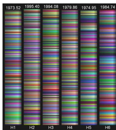
図 5 各 CN（データ処理ノード）6 コアを用いたロードバランス（ノード毎の処理および I/O 時間）：それぞれのブロックの高さがデータファイルごとの処理時間と I/O 時間の和を示す
