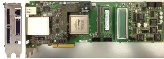
図 3 PEACH2 試作ボードの写真 (左：パネル面, 右：基板面)
