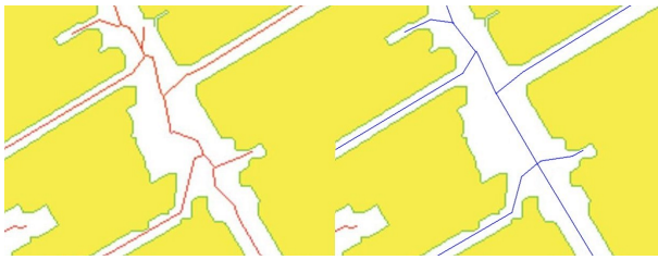
図 7 広場内道路補正アルゴリズムを用いない場合 (左) と広場内道路補正アルゴリズムを用いた場合 (右)
