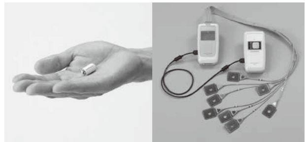
図-3 カプセル内視鏡（左：カプセル内視鏡 右：受信装置） 画像提供 オリンパスメディカルシステムズ（株）
