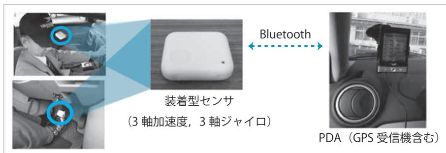
図-1 運転者行動センシングに用いた機器
