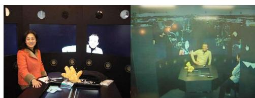
t-Room は同室感(離れた部屋が空間的に一致している感覚)を得るために次世代テレビ会議システムである(写真). t-Room はモノリスと呼ばれるモジュールから構成される. 各モノリスは、ディスプレイとそのディスプレイの面を撮影するカメラ、及びそれらを制御するPCから構成されている. 基本的な動作は、カメラで撮影された映像が遠隔地に送られ、対応するモノリスのディスプレイに表示される. カメラとディスプレイの関係が2地点でループになるので、それをキャンセルするために偏光フィルタを用いている. モノリスに囲まれた部屋をつくり、人がディスプレイに接した位置に立つと、あたかも遠隔地と部屋が重なっているように感じられる.
