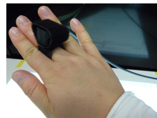
図 13 磁気センサ装着例 Fig. 13 Usage of FASTRAK.
