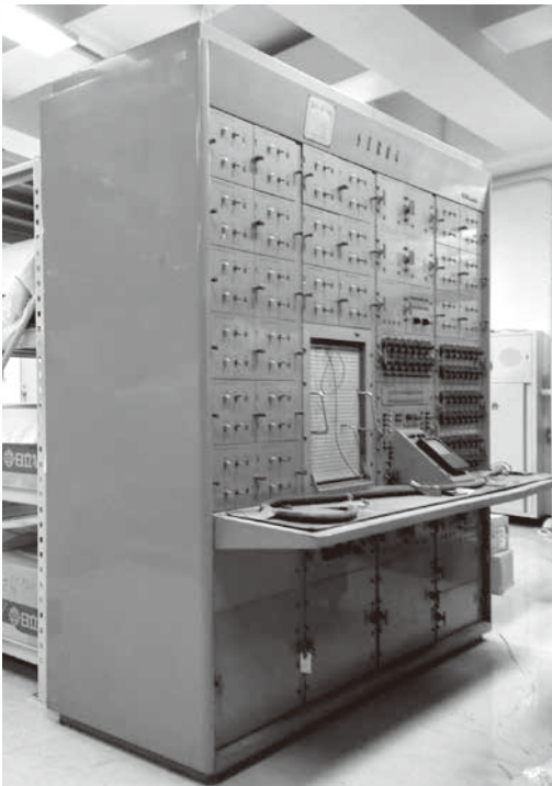
図-2 霞が関ビルの設計に使用されたアナログ計算機 SERAC (国立科学博物館所蔵)
