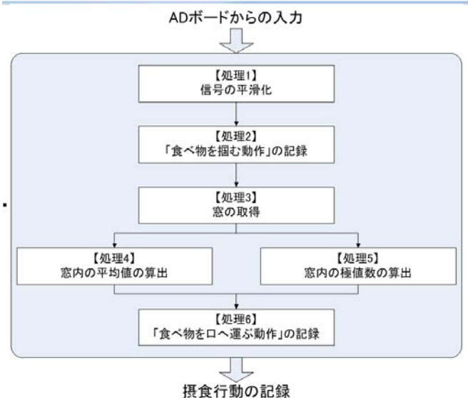
図 12 信号処理の流れ
