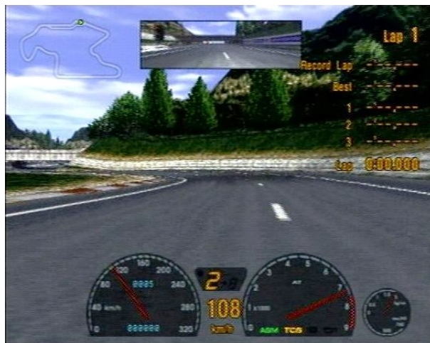
図 3 グランツーリスモ 3 のゲーム画面。画面左下のスピードメータの針の位置から速度を取得する。
