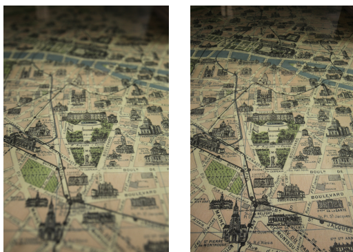
(a) (b) 図 4 (a)チルト効果なし (b)チルト効果あり Fig. 4 (a)Before tilt. (b)After tilt.
