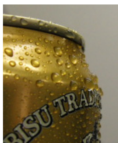
図 9 垂直物体面上での水滴の実例。液滴が小さい場合は一価関数で形状を記述してもよいことがわかる。
