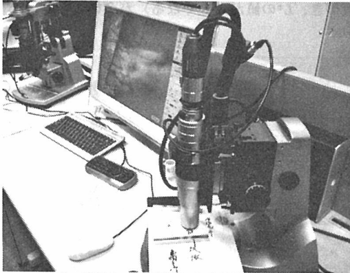
図.2 デジタル顕微鏡による料紙の表面観察
