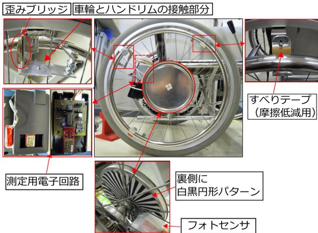
図 4 ハンドリム駆動力測定用手動車いすへの実装写真
