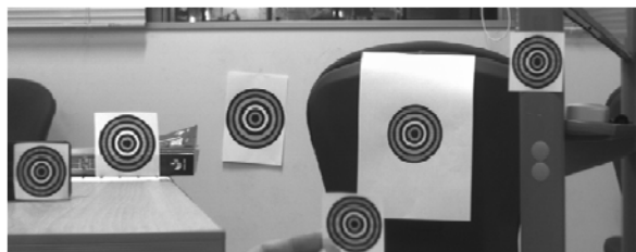
図 9 校正に用いたマーク Figure 9 Marks used for rectification
