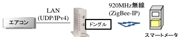
図 2 2つのサブネットにまたがる HEMS の例
