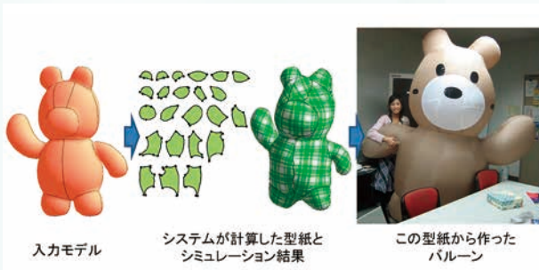
図-5 Pillow 5) を用いて既存モデルへ縫い目をデザインしてぬいぐるみやバルーンを作成する
