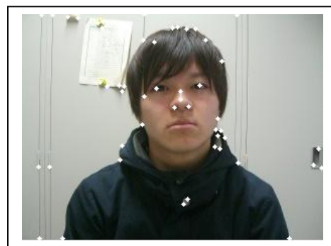
図3 Harris コーナー検出アルゴリズムで検出されたコーナー点の画像例
