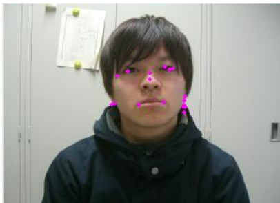
(c) FASTで検出されたコーナー点(提案手法:明度正規化後)
