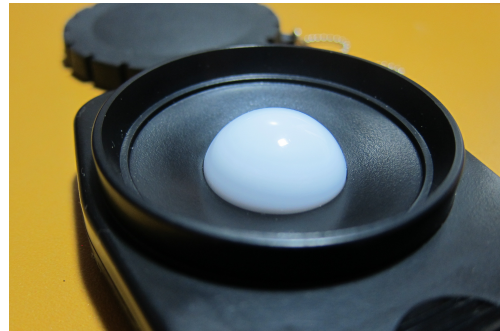
図2 照度計受光部の形状
