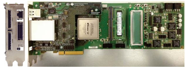
図 5 PEACH2 試作ボードの写真 (左: パネル面, 右: 基板面)
