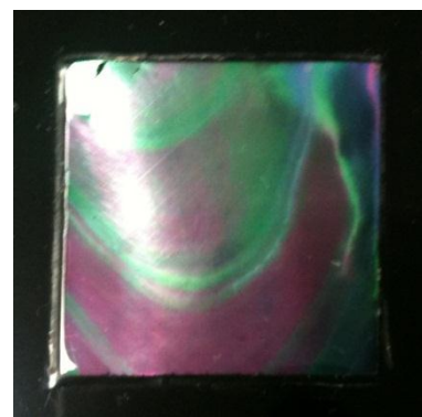
図1 夜光貝を用いた測定用の螺鈿
