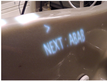
図 9 浴槽内壁への表示
