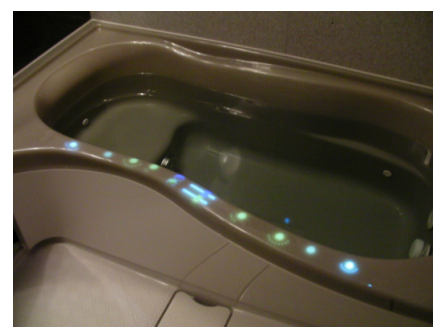
図4 TubTouch を用いた調光照明の操作画面の表示例
