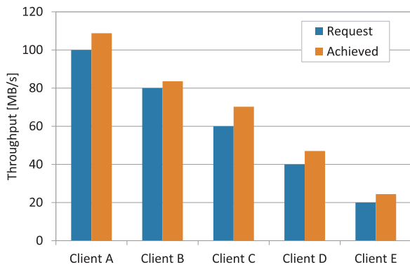
図 6 5クライアントによる同時ダウンロード時の性能制御
