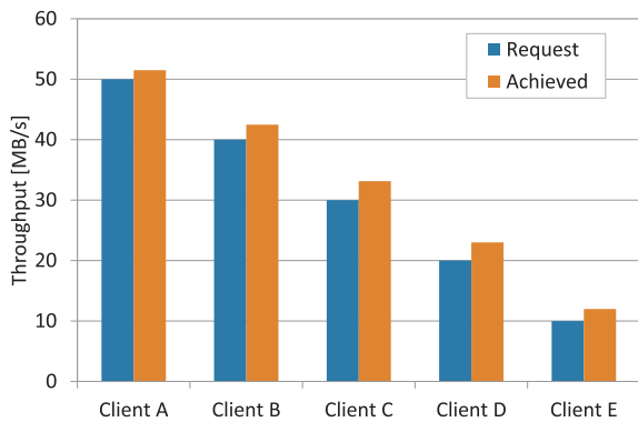
図 7 5クライアントによる同時アップロード時の性能制御
