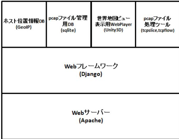
図 10 本システムの Web アプリケーションサーバの構成
