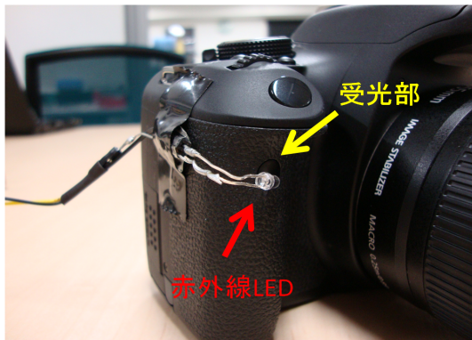
図 7 カメラの受光部に赤外線 LED を取り付けられた様子
