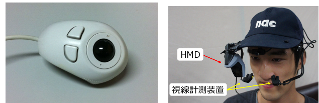
図2 ハンドヘルドマウス 図3 装置の装着例 Fig. 2 Handheld mouse. Fig. 3 A snapshot of wearing equipment.
