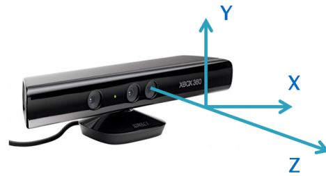
図 3 Kinect コントローラとその座標系
