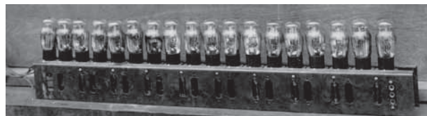
◀ 我が国最初の真空管による10進カウンタ
